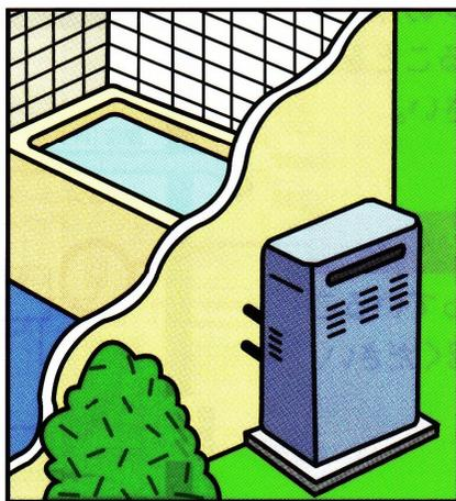
●屋外設置式(RF式)：機器を屋外に設置。給排気設備は必要なく、最も安全な機器です。
