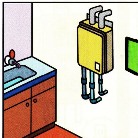
●密閉式(FF式)：ファンの力で空気を屋外から取り入れ、排気も強制的に屋外へ排出します。
