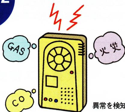
「ガス漏れ警報器」には、24時間ガス漏れを見張るほか、不完全燃焼で発生した一酸化炭素 (CO) を検知したり、火災警報機が付いた“複合型”もあります。設置しておくとお安心です。有効期間 (5年) が終了したら、お取り替えが必要です。
