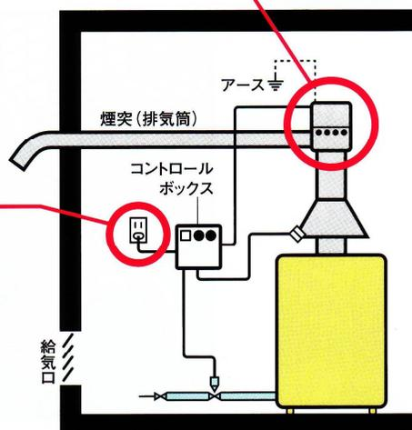
※煙突があり、排気ファンが付いている「屋内設置型湯沸器・風呂がま」とは：ガスを燃やすための空気を屋内からとり、燃焼排ガスを排気ファンを使用して、排気筒で屋外に排出する方式です。半密閉式ガス機器と呼ばれます。
